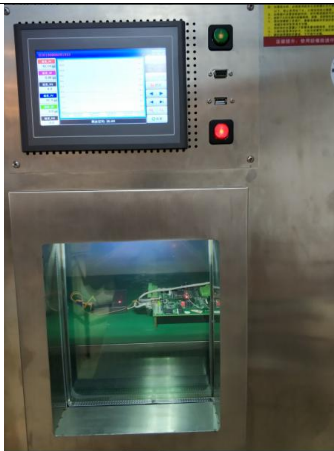
TW-IMX6UL-CB01 V1.0 主板在内部进行测试
