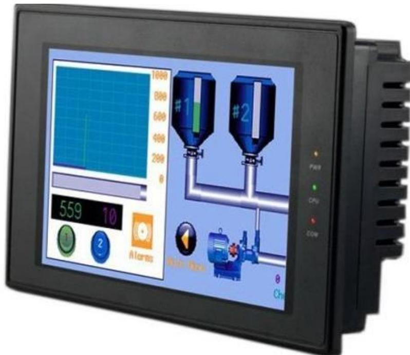
图 5.2 基于 MIPI\_HDMI&LVDS-LT8912B 模块人机界面显示
