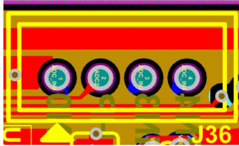
图 3.18 ADC 模拟信号接口
