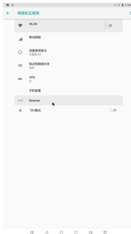
点击“Ethernet”可以选择自动获取 IP DHCP 或者静态 IP。推荐使用 DHCP，如果设置静态 IP，请确保您的网络参数可用。
