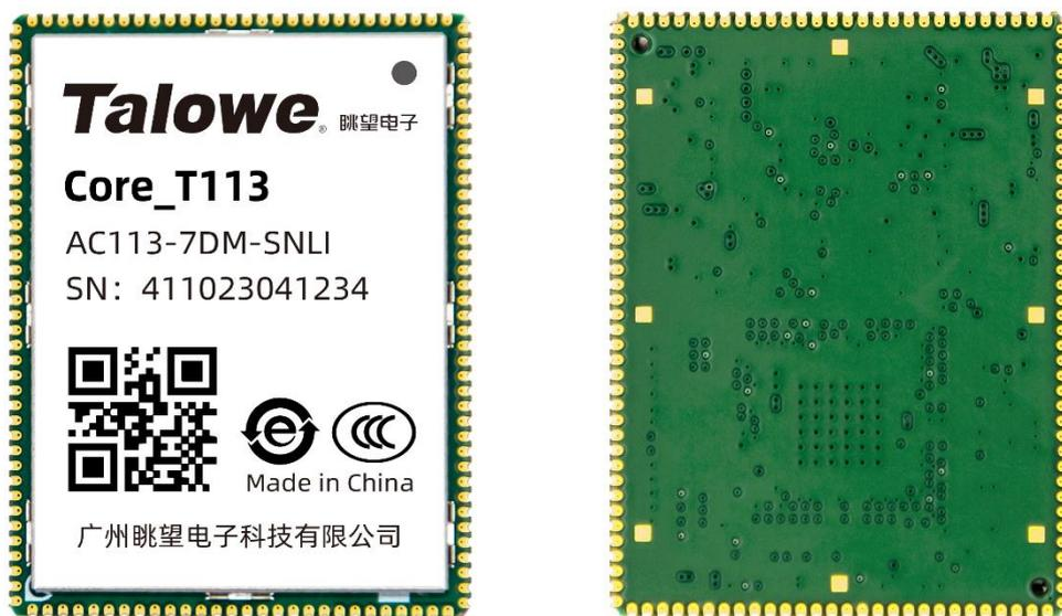
图 3.1 Core-T113-S3/S4 核心板正反面
